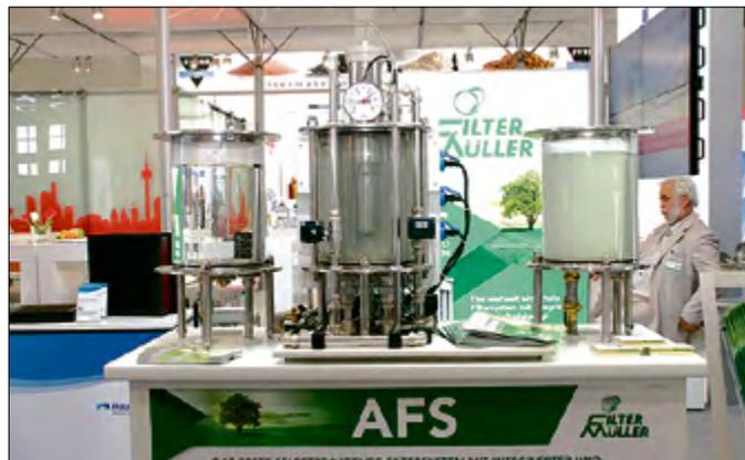
▲ **Das AFS-Filterssystem von Filter-Müller aus Berlin ist einfach, aber das erste selbstreinigende Filtersystem mit integrierter und vollautomatischer Ultraschallreinigung. Vorteile: Der Wartungsaufwand ist gering, weil kein Filterwechsel nötig ist. Damit werden Ressourcen geschont und Kosten reduziert.**
